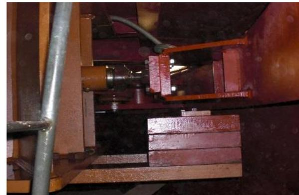
Schwinge mit Federdrucklagerung und Kontergewicht
